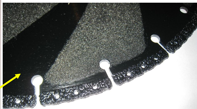
Udsnit af diamantskær. Der er desuden belægning langs klingen for bedre friskæring af klingen.
